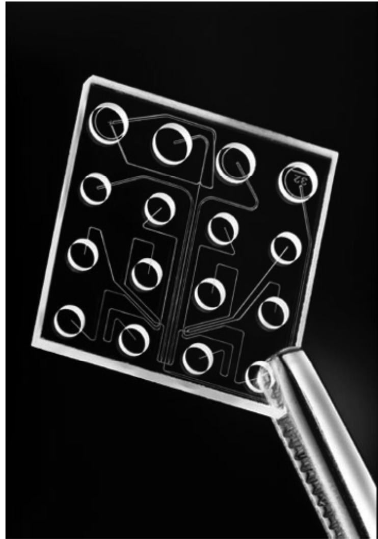
Figure 4.9. Puce commercialisée par la société Caliper permettant une séparation par électrophorèse. Les microcanaux ont été remplis d'un liquide coloré permettant de les visualiser.
